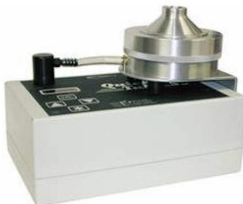
شکل ۲۲: ایمپکتور (Quik Take) مورد استفاده برای نمونه برداری بیوآئروسول
