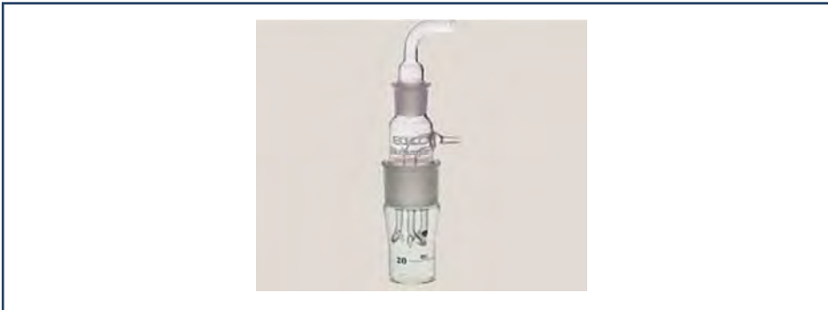
شکل ۵- بیوسمپلر مورد استفاده برای نمونه برداری بیوآئروسل (حاوی سه جت ایجاد کننده برخورد در سطح مایع)
