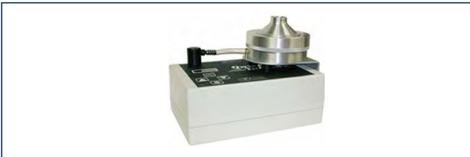
شکل ۶- ایمپکتور (Quik Take) مورد استفاده برای نمونه برداری بیوآئروسل
