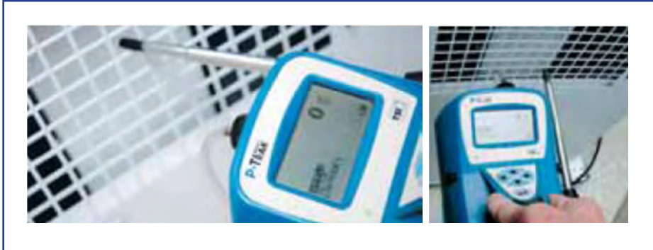
شکل ۱۳- استفاده از شمارشگر ذرات برای تعیین کارایی فیلتراسیون
