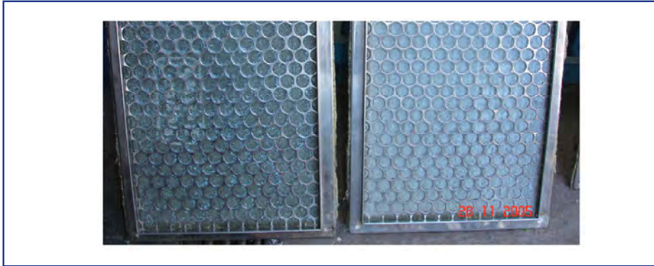
شکل ۷- تجمع ذرات بر روی سطح فیلتر کثیف (سمت چپ) و مقایسه با فیلتر تمیز (سمت راست)
