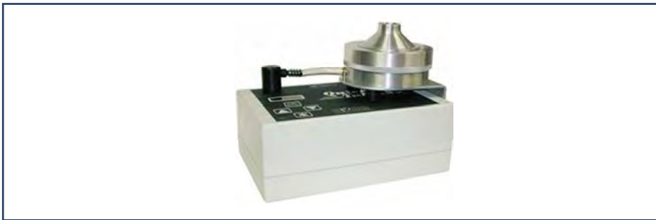
شکل ۶- ایمپکتور (Quik Take) مورد استفاده برای نمونه برداری بیوآئروسول
